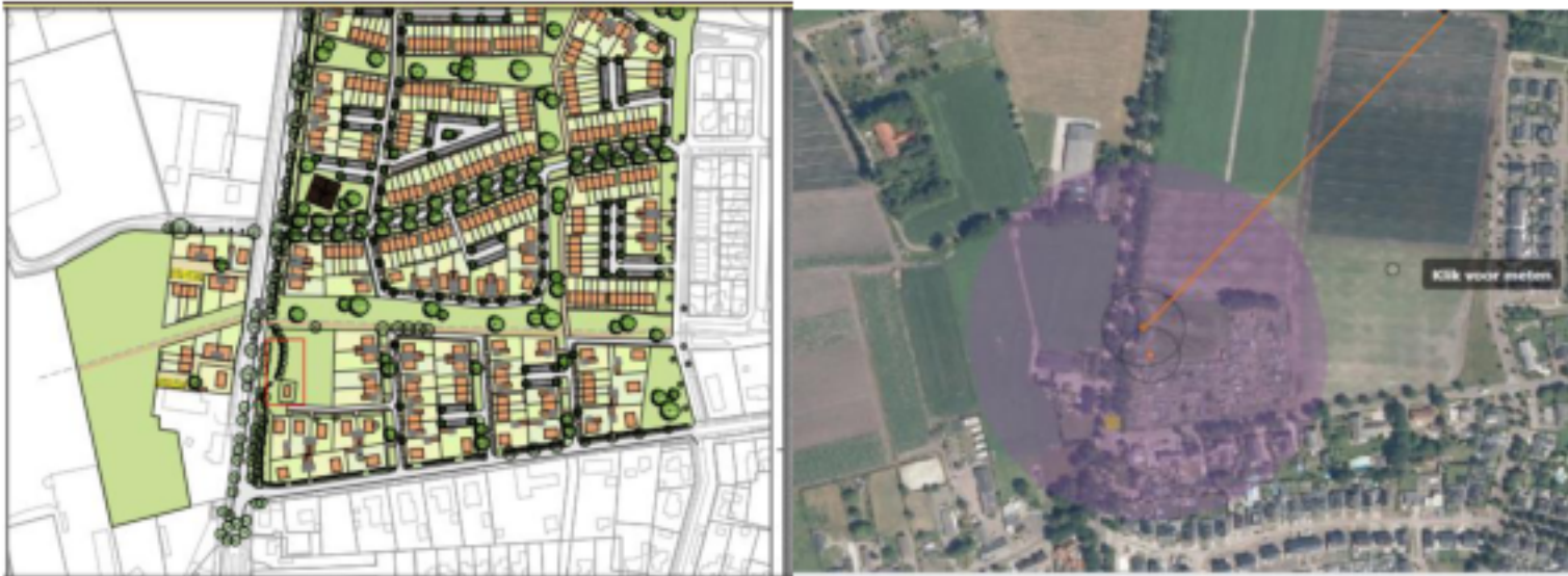
1 Paars: markering invloedsgebied van het vulpunt. Tot en met 380 meter (oranje lijn) kan bij een warme BLEVE kan hittestraling nog 10kW/m 2 bedragen.
