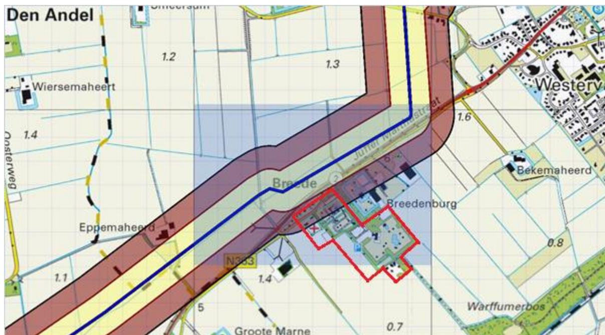
Figuur 3: Invloedsgebied leiding A-606 (geel = 100% letaliteit, bruin = 1% letaliteit) en grens plankaart Breede (rood)
