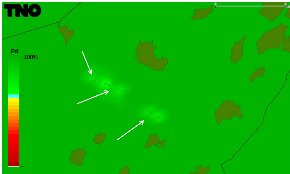
Figuur 7 Detectiekans van het primaire verkeersleidingsradarnetwerk op 1000 voet boven het bouwplan nadat deze is gerealiseerd. De locatie van de nieuwe windturbines is aangegeven met gele stippen.
