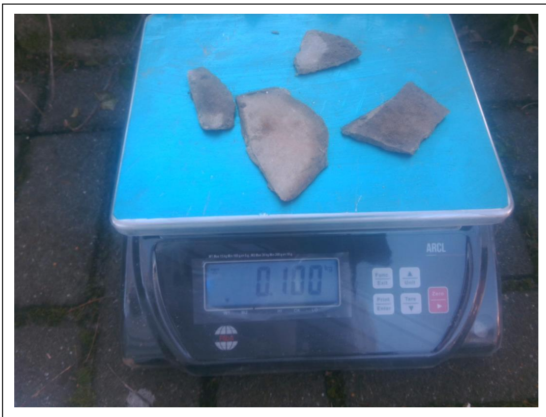
Foto 5. Asbestverdacht (plaat)-materiaal sleuf 03
