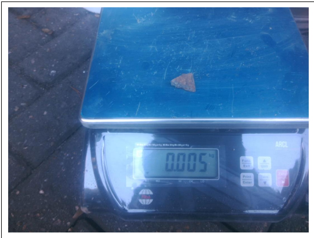
Foto 15. Asbestverdacht (plaat)-materiaal sleuf 07, vlakke plaat, donkergrijs
