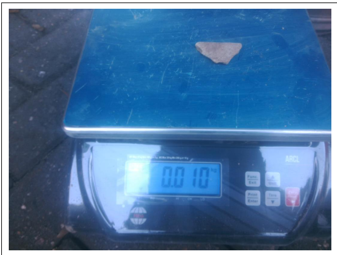
Foto 14. Asbestverdacht (plaat)-materiaal sleuf 07, dunne, vlakke plaat, lichtgrijs
