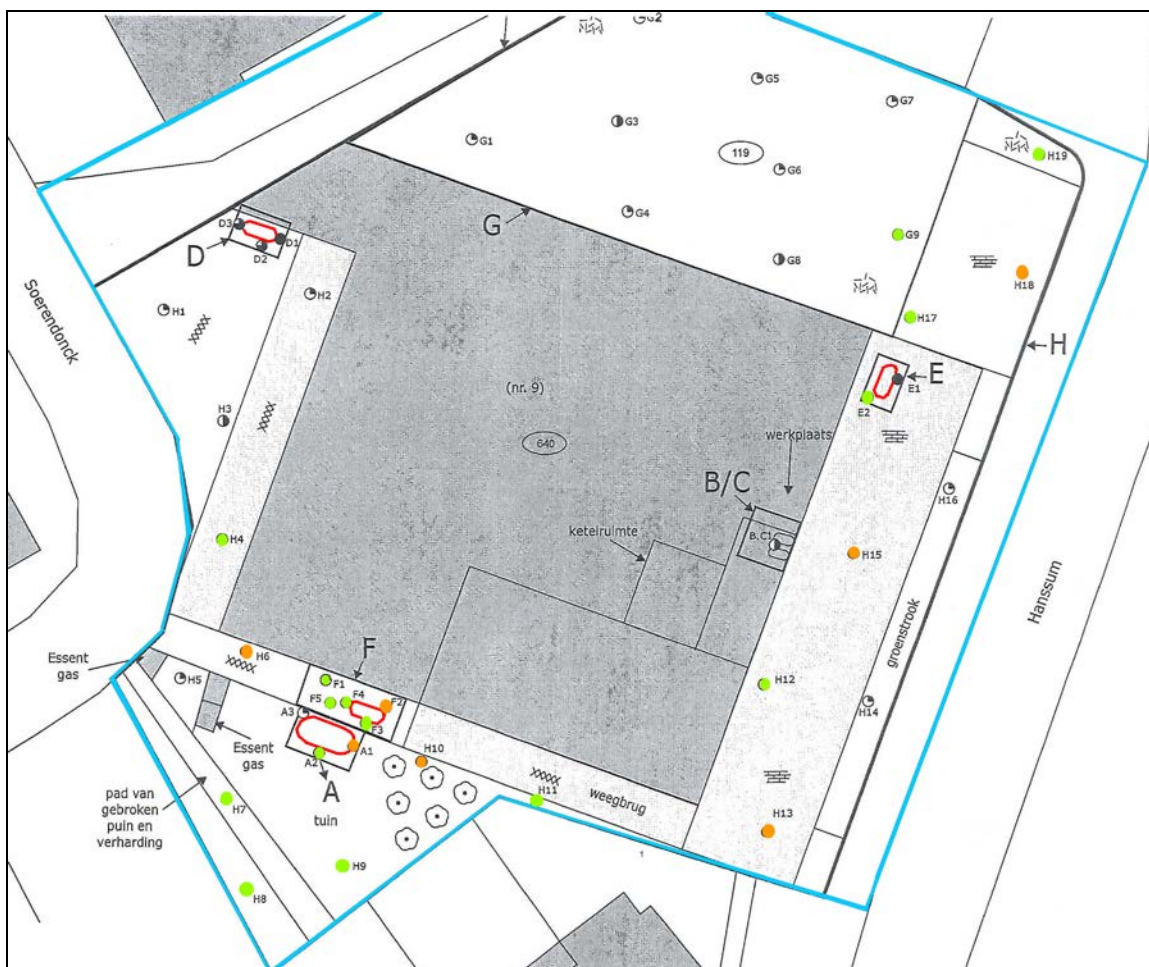
Afbeelding 18. De bewerkte boorpuntenkaart van het milieukundig bodemonderzoek in 2009. De rood omkaderde zones betreffen de locaties van de voormalige ondergrondse olietanks. Ter plaatse van de groen gemarkeerde boringen werd baksteenpuin aangetroffen tot een diepte van maximaal 0.5 meter beneden het maaiveld. Ter plaatse van de oranje gemarkeerde boringen werd baksteenpuin aangetroffen tot een diepte van circa 1.0 meter beneden het maaiveld.
