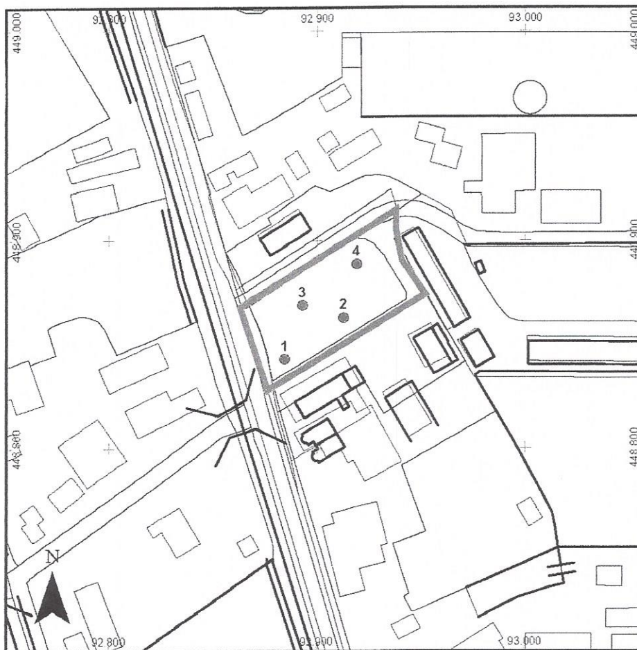
Afbeelding 6. De positie van de boorpunten van het IVO (in blauw), geprojecteerd op een uitsnede van de Kadastrale kaart van het onderzoeksgebied. Het onderzoeksgebied is rood omkaderd. Schaal 1: 2500.
