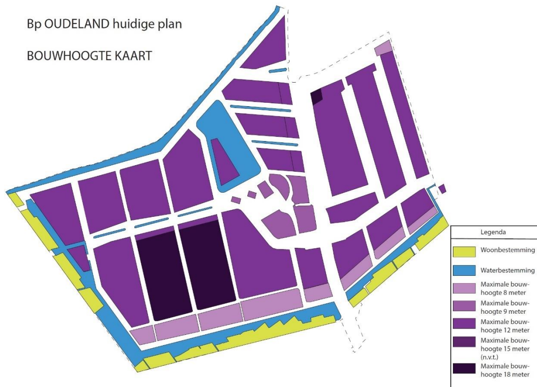
Afbeelding 2.3: Maximale bouwhoogten op bedrijventerrein Oudeland in de bestaande situatie
