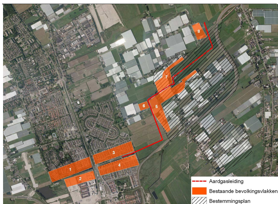
Figuur 3.9 Overzicht bevolkingsvlakken binnen invloedsgebied aardgastransportleiding (op de kaart is alleen het bestemmingsplangebied Oostland-Berkel gearceerd)
