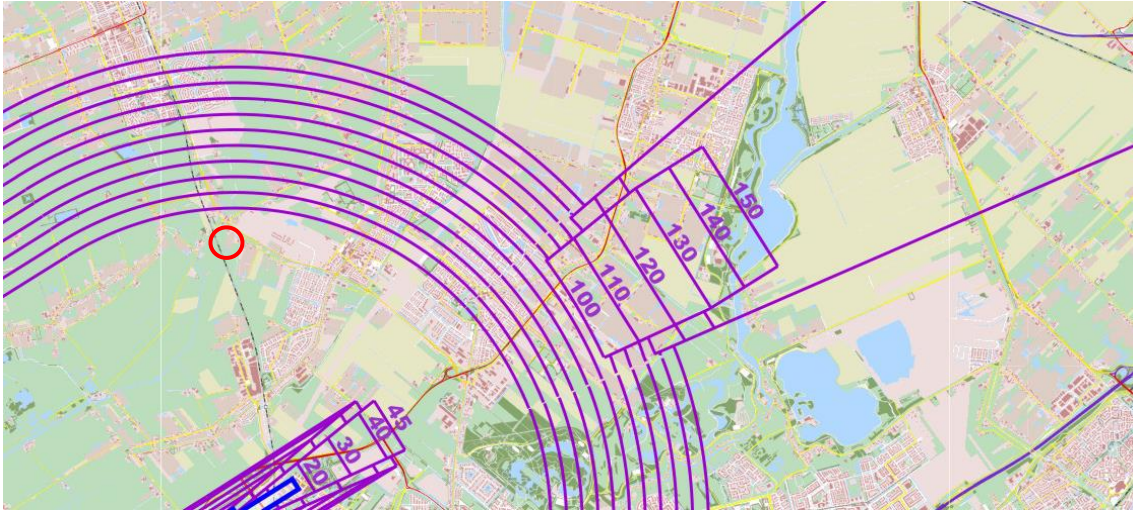
Afbeelding 2.7.: uitsnede kaart hoogtebeperkingen invliegfunnel Rotterdam The Hague Airport. Het plangebied is in rood aangegeven.
