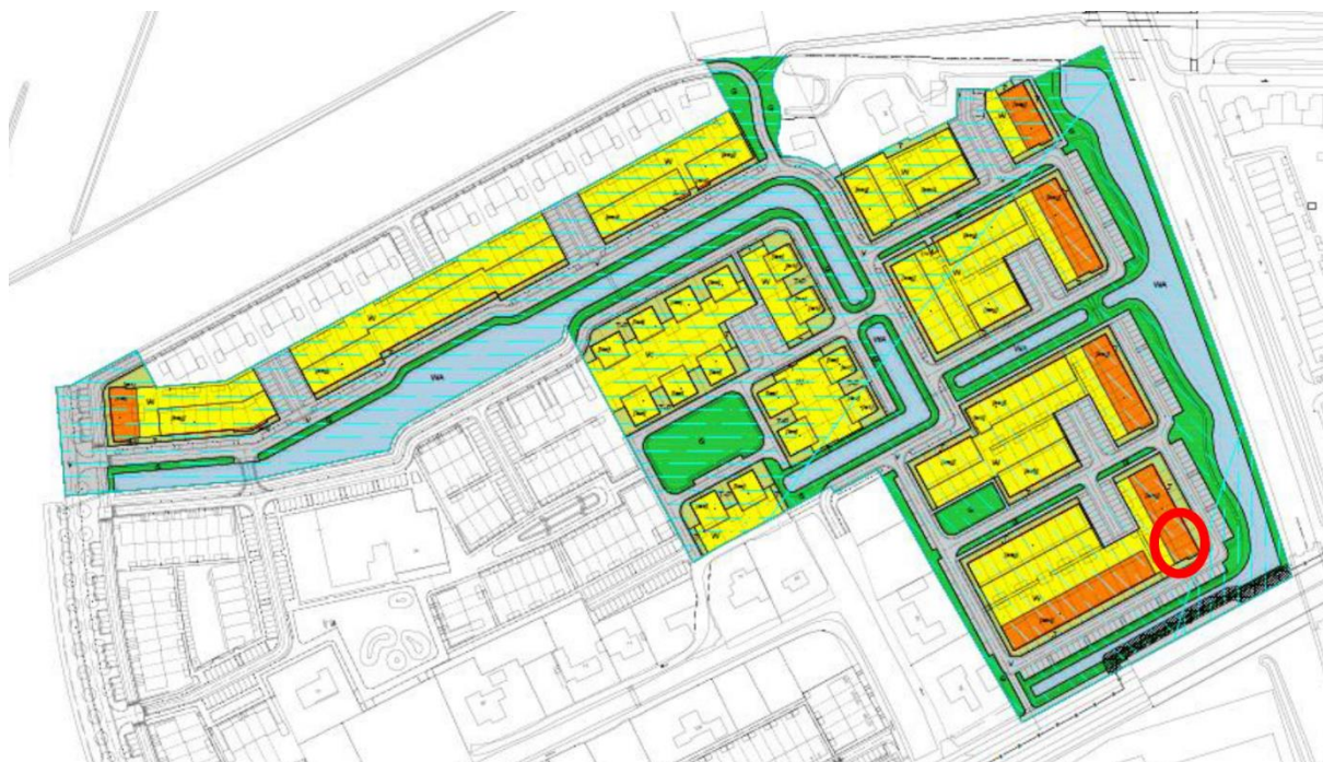
Afbeelding 2.3: Situering bouwvlakken waar de voorkeurswaarde van weg- en of railverkeerslawaai wordt overschreden.
