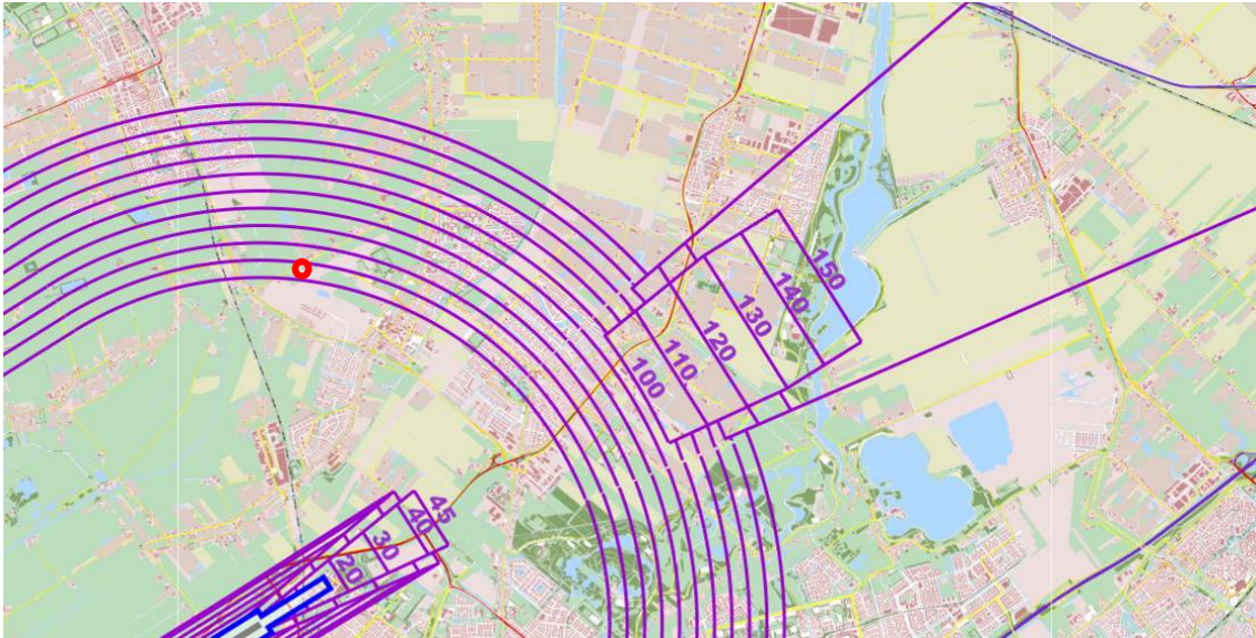
Afbeelding 2.11: uitsnede kaart hoogtebeperkingen invliegfunnel Rotterdam The Hague Airport. Het plangebied is in rood aangegeven.
