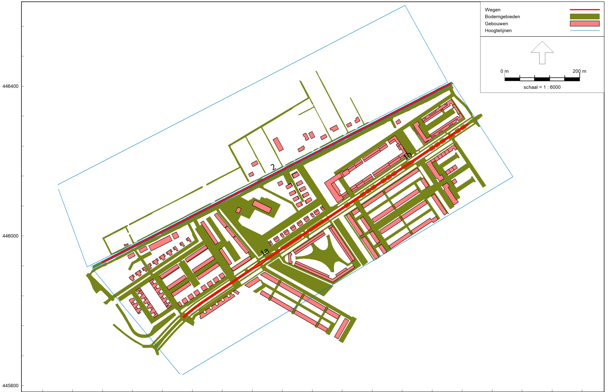
Overzicht rekenmodel wegverkeerslawaai conform Standaardrekenmethode 2 Plansituatie 2028
