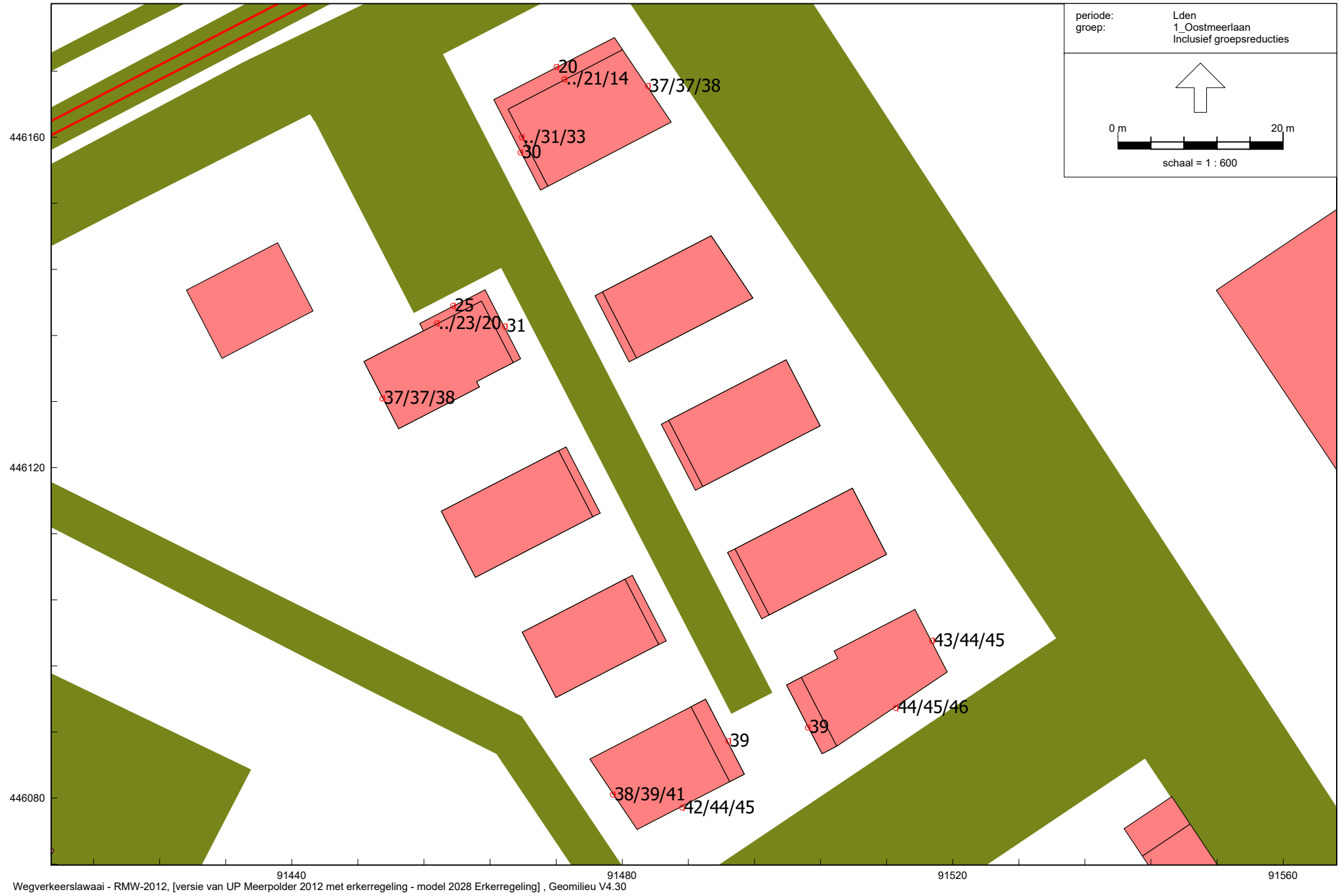
Berekeningsresultaten Oostmeerlaan plansituatie 2028 Waarden met aftrek 5 dB ex artikel 110g Wgh.
