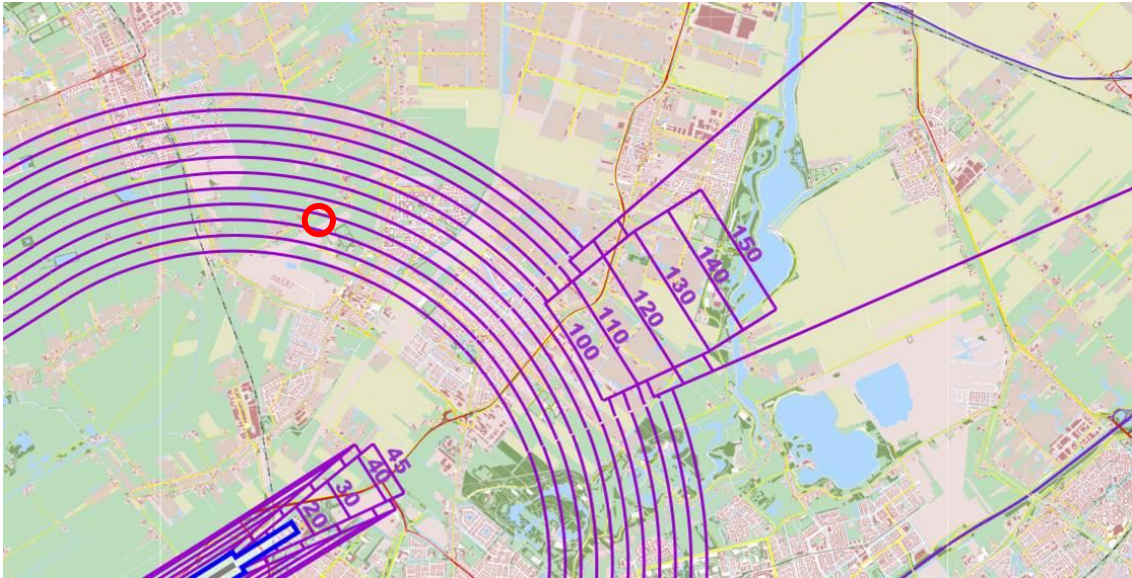
Afbeelding 2.9.: uitsnede kaart hoogtebeperkingen invliegfunnel Rotterdam The Hague Airport. Het plangebied is in rood aangegeven.
