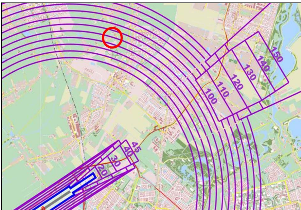
Afbeelding 2.9.: uitsnede kaart hoogtebeperkingen invliegfunnel Rotterdam The Hague Airport. Het plangebied is in rood aangegeven.
