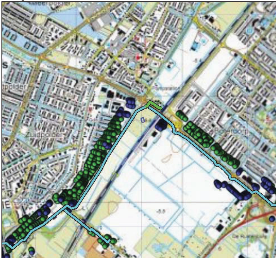
Figuur 4.2 Kilometer leiding behorende bij de maximale overschrijding van de FN-curve voor leiding-W-521-05-deel-1 van N.V. Nederlandse Gasunie
