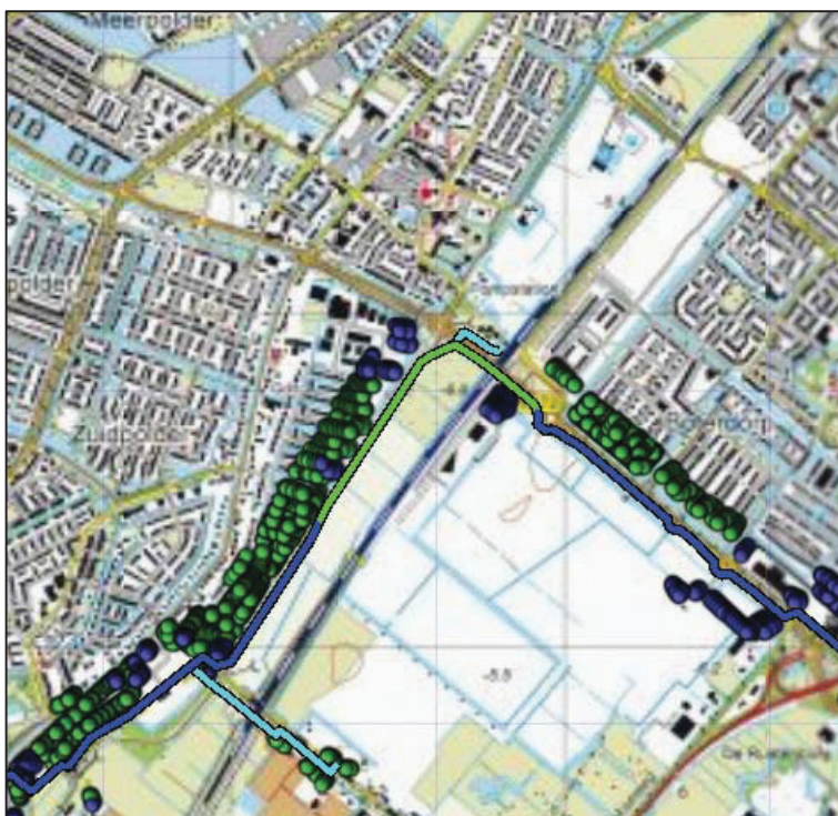
Figuur 4.1 Kilometer leiding behorende bij de maximale overschrijding van de FN-curve voor leiding-W-521-01-deel-1 van N.V. Nederlandse Gasunie
