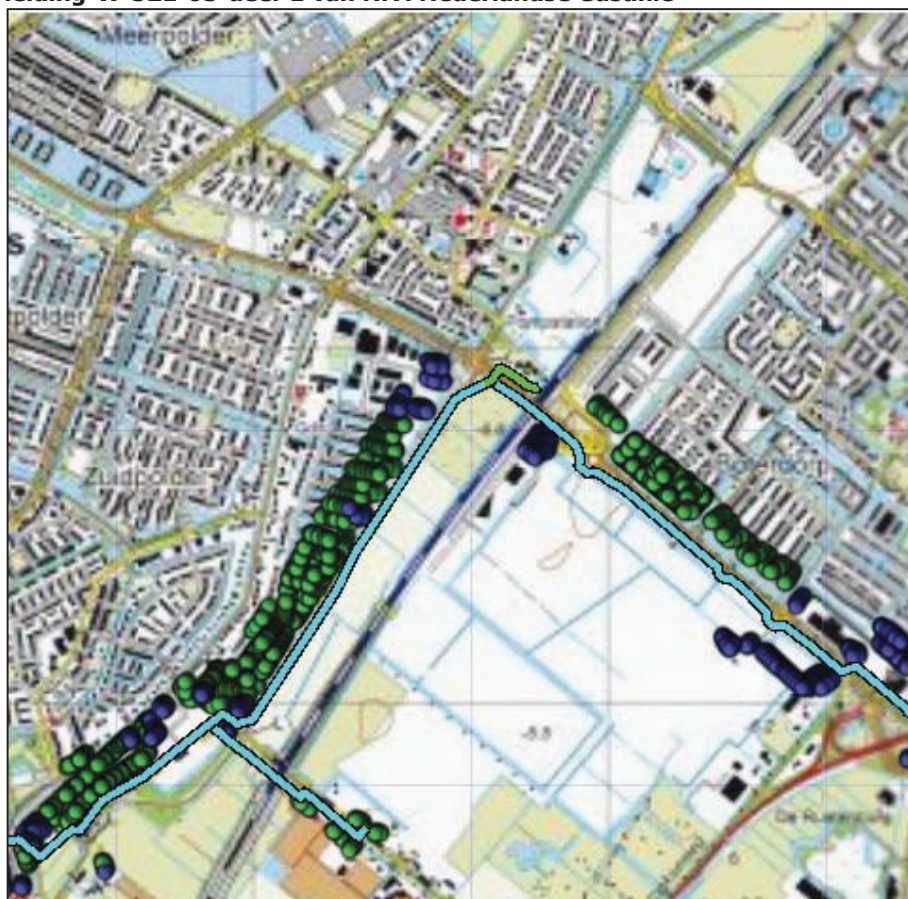
Figuur 4.2 Kilometer leiding behorende bij de maximale overschrijding van de FN-curve voor leiding-W-521-05-deel-1 van N.V. Nederlandse Gasunie
