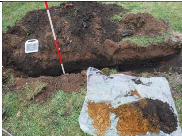
Boring 108, gezet in de basis van een sleuf die gegraven is t.b.v. het milieukundig bodemonderzoek
