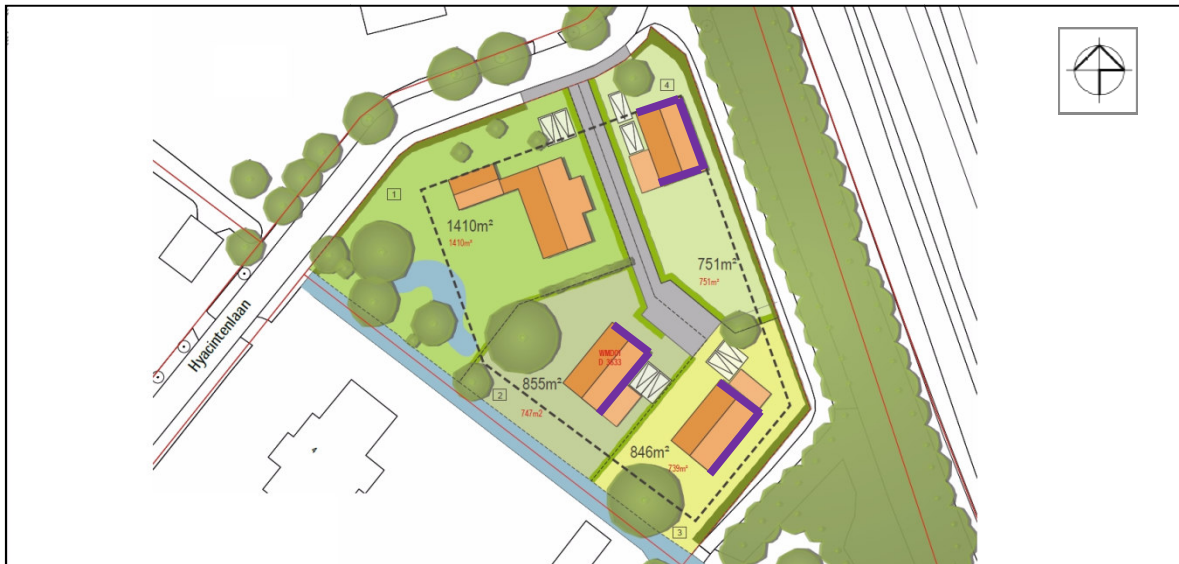
Figuur 5.1: Gevels met normoverschrijding op de eerste verdieping ten gevolge van railverkeer
