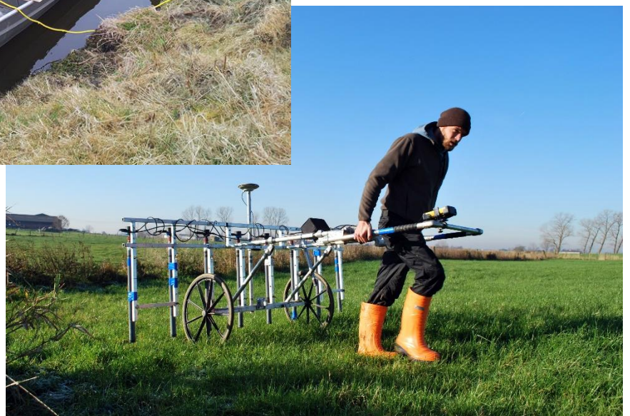
Fig. 3b: Het Multi-sonde systeem (VXV4-8 Vallon) met aluminium detectiekar
