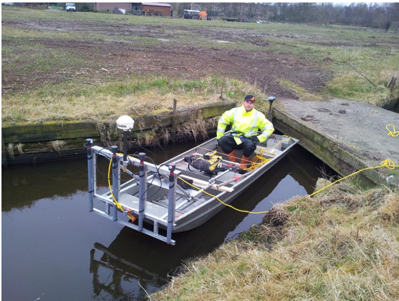
Fig. 3a: Het Multi-sonde systeem (VXV4-8 Vallon) gemonteerd op een aluminium boot.
