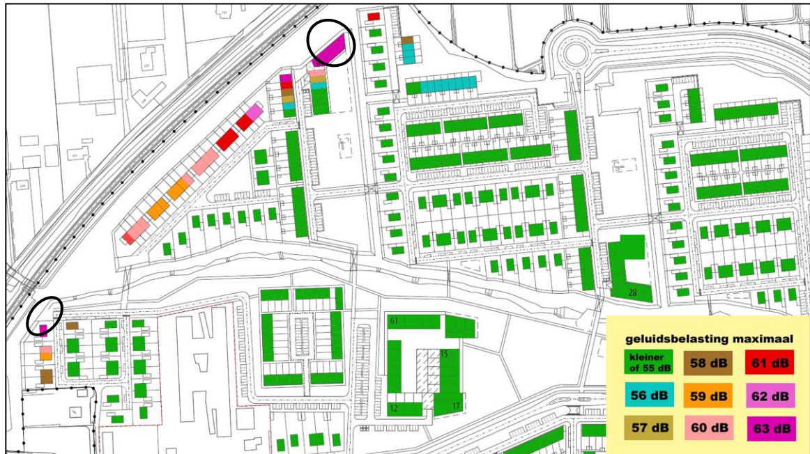
Afbeelding 6.1 | Geluidsbelasting met een 2 meter hoog geluidscherm, omcirkeld zijn de twee locaties waar een geluidsbelasting geldt van 64 dB
