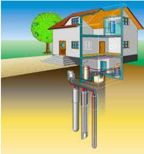
Figuur 3 - 3 Woning met een individuele bodemwarmtewisselaar (verticaal).
