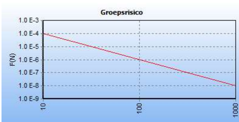
5.2 Figuur 5.2 FN curve voor 2867_leiding-N-569-72-deel-1 van N.V. Nederlandse Gasunie voor de kilometer tussen stationing 1280.00 en stationing 2280.00
