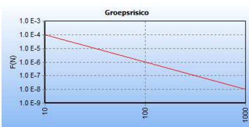
5.2 Figuur 5.2 FN curve voor 2867_leiding-N-569-72-deel-1 van N.V. Nederlandse Gasunie voor de kilometer tussen stationing 1280.00 en stationing 2280.00
