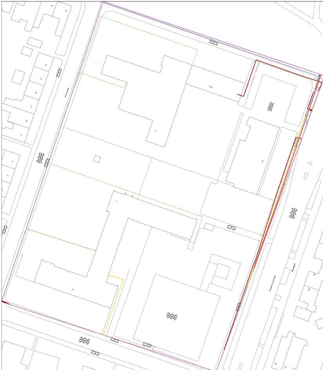
Afb. 5 Een overzichtstekening van de ligging van kabels en leidingen binnen het plangebied (bron: KLIC, Kadaster. De Klacmelding is op 10-11-2010 verricht en is maximaal 2 maanden geldig. De ligging van de kabels is indicatief)
