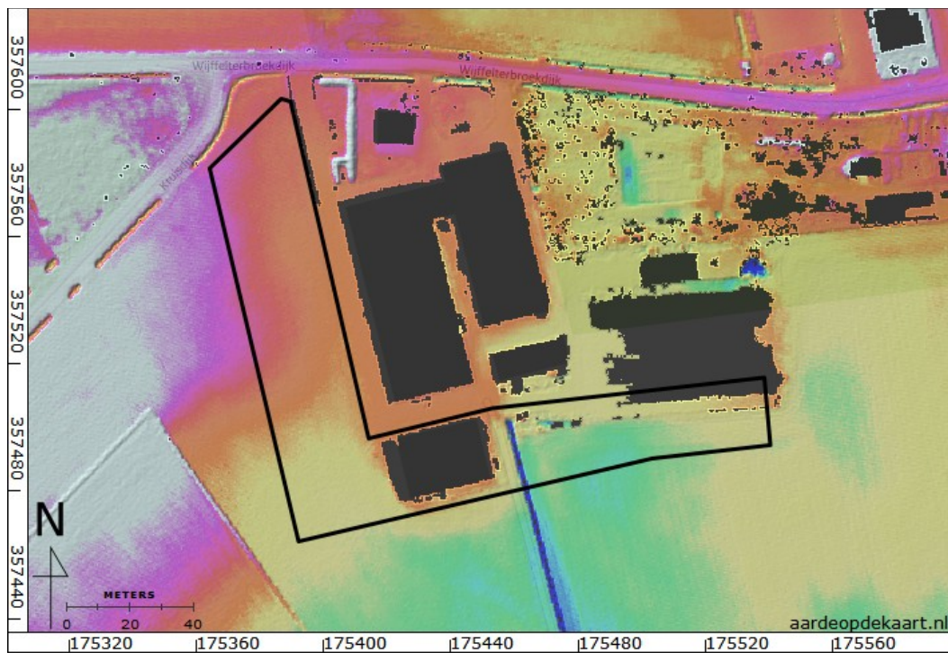
Figuur 7: Ahn, detail. Legenda: geel/groen = ca. 31,5 m NAP, oranje = ca. 32 m NAP en roze/licht grijs = ca. 32,5 m NAP.
