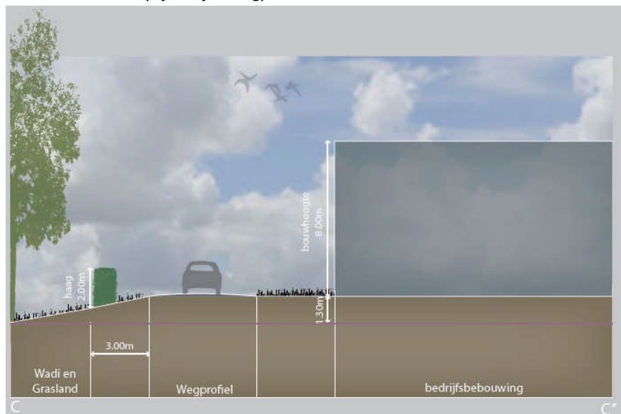
Opvang hoogteverschil in beplante grastaluds
