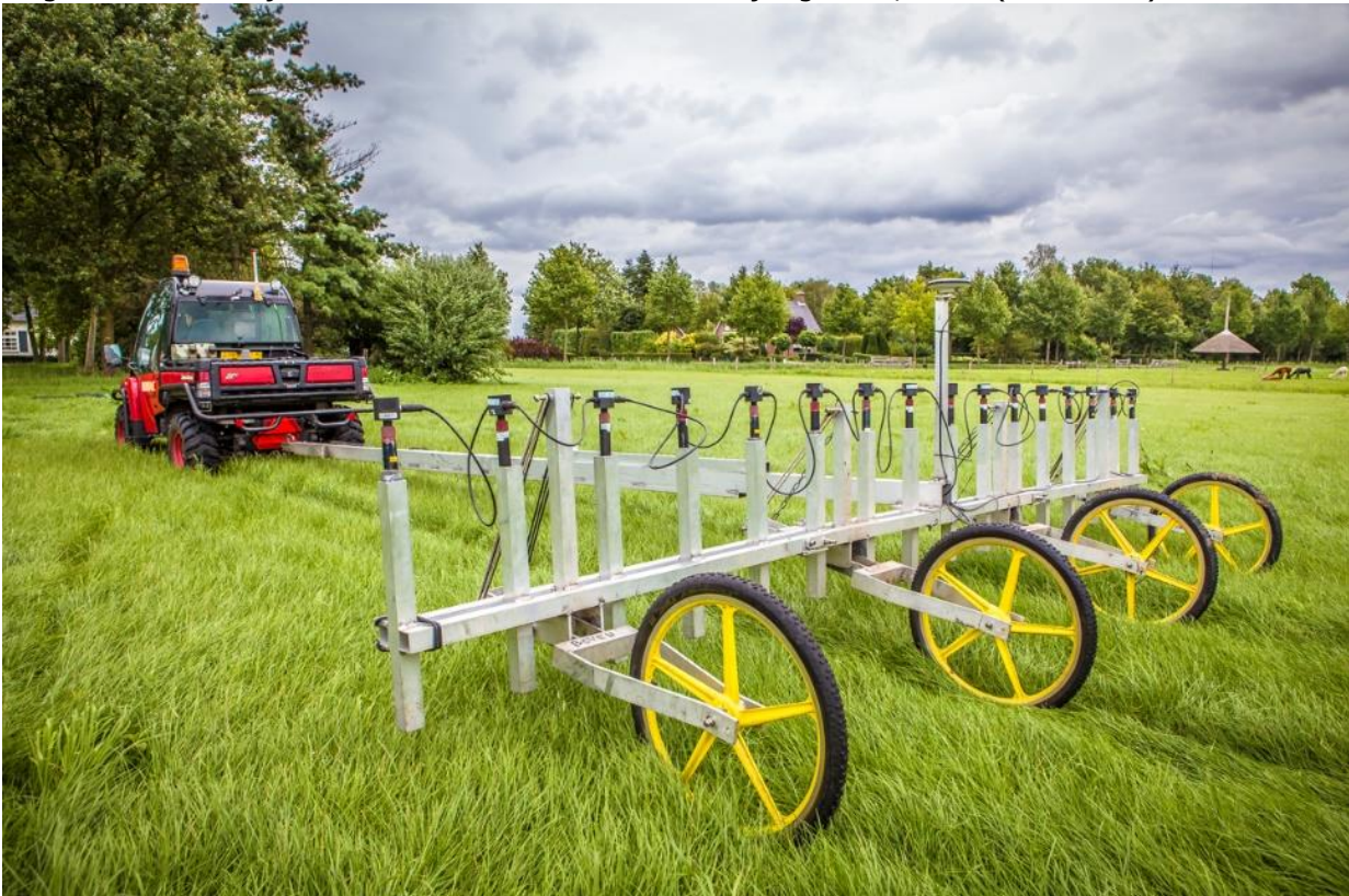
Afbeelding 6. Detectievoertuig zoals deze gebruikt is voor het uitvoeren van de computerondersteunde digitale oppervlakedetectie.
