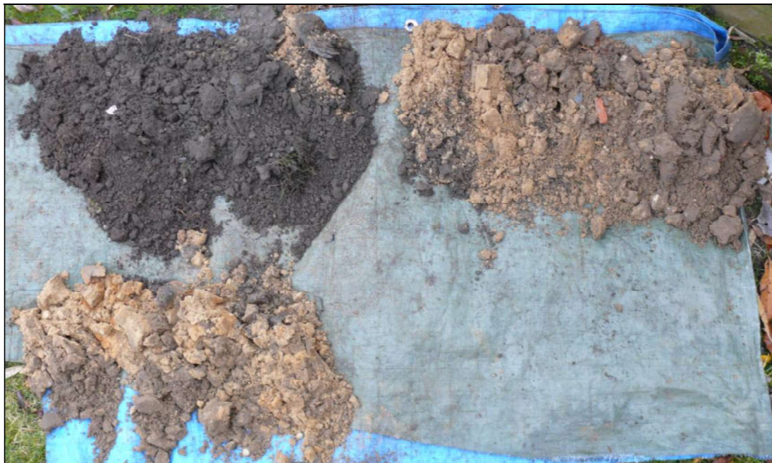
Figuur 7: Boring 5 (0-120 cm –mv) uitgelegd van linksboven naar rechtsonder.
