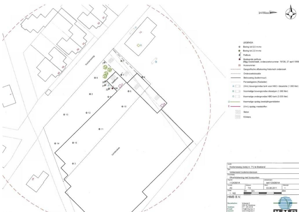
Afbeelding 17: Boringen en peilbuizen onderzoekslocatie
