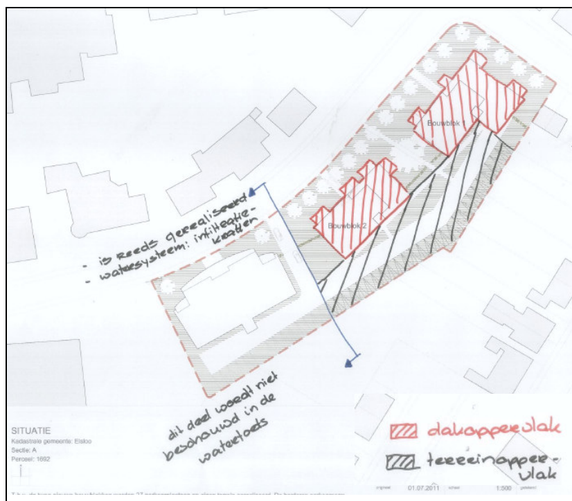
Afbeelding 1: Overzicht verhard oppervlak in plangebied.
