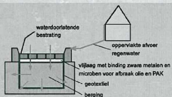
Figuur 2: Waterdoorlatende bestrating met zuiverende werking
