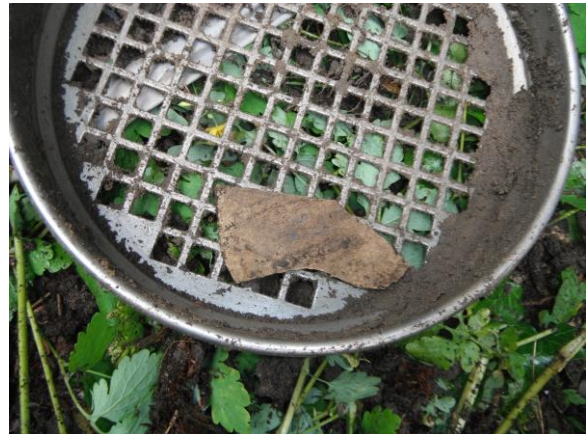
ABG10 asbesthoudend plaatmateriaal 0-0,2 m-mv
