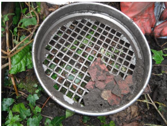
ABG11 asbesthoudend plaatmateriaal 0,2-0,5 m-mv
