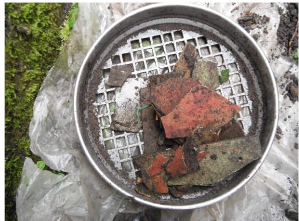
ABG11 asbesthoudend plaatmateriaal 0-0,2 m-mv
