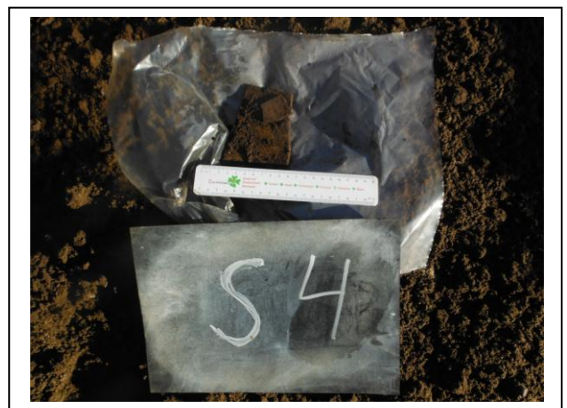
Foto 11. Aangetroffen asbestverdacht materiaal sleuf S04
