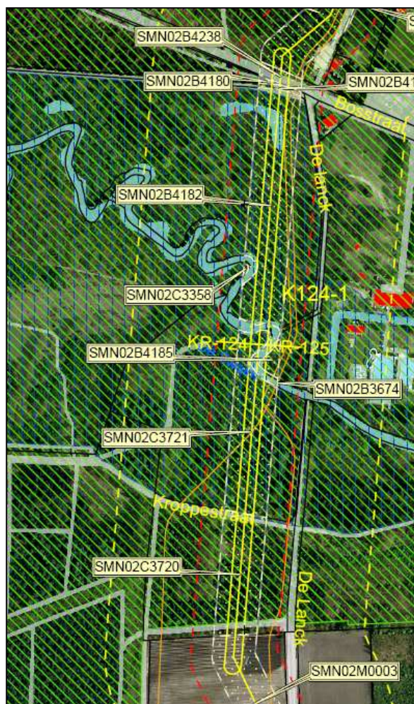
Afbeelding 13: weergave HDD-boring onder het Swalmdal door
