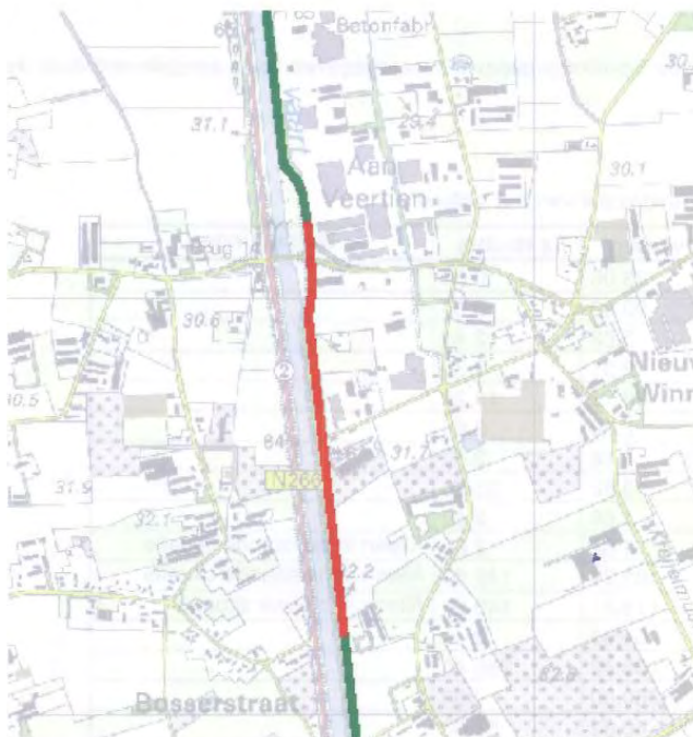
Figuur 5 Worst-casesegment van de Z-540-01-KR-064 t/m 068, weergegeven in rood. Dit segment levert het hoogste groepsrisico op in de nieuwe situatie.
