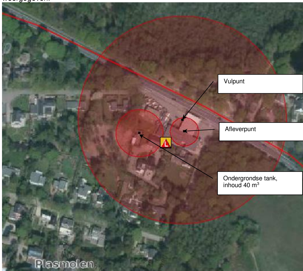
Figuur 2 Ligging installaties (de rode contouren zijn de PR 10 6 contouren van de betreffende installatie)
