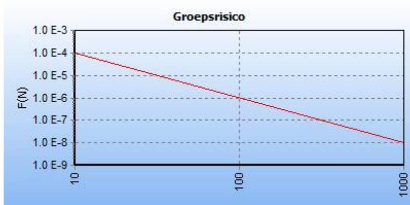
5.1 Figuur 5.1 FN curve voor Z-530-17 nieuwe leiding van N.V. Nederlandse Gasunie voor de kilometer tussen stationing 0.00 en stationing 1000.00
