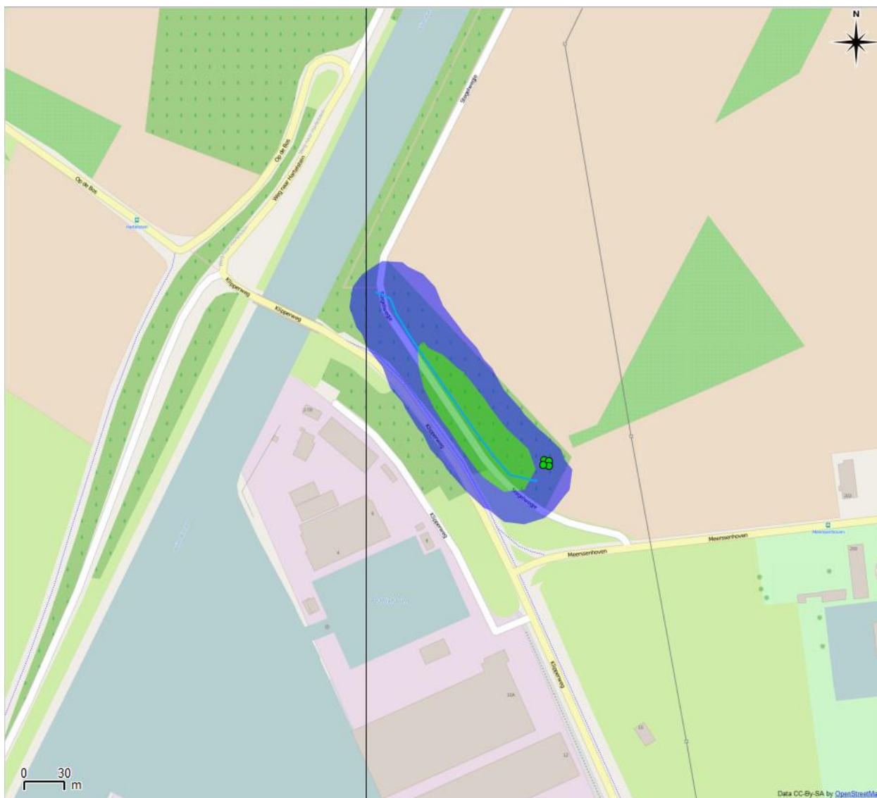
Figuur 3 Ligging van gastransportleiding Z-530-13 (lichtblauw) in de huidige situatie. De plaatsgebonden risicocontouren rondom de leiding zijn, wanneer aanwezig, weergegeven met de volgende kleuren:
