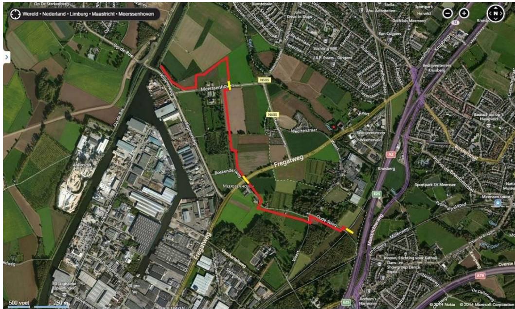
figuur 2.1. Luchtfoto van het plangebied met de te plaatsen leidingen in open ontgraving (rood). De gele aanduidingen betreffen boringen. (Bron: Bing maps)
