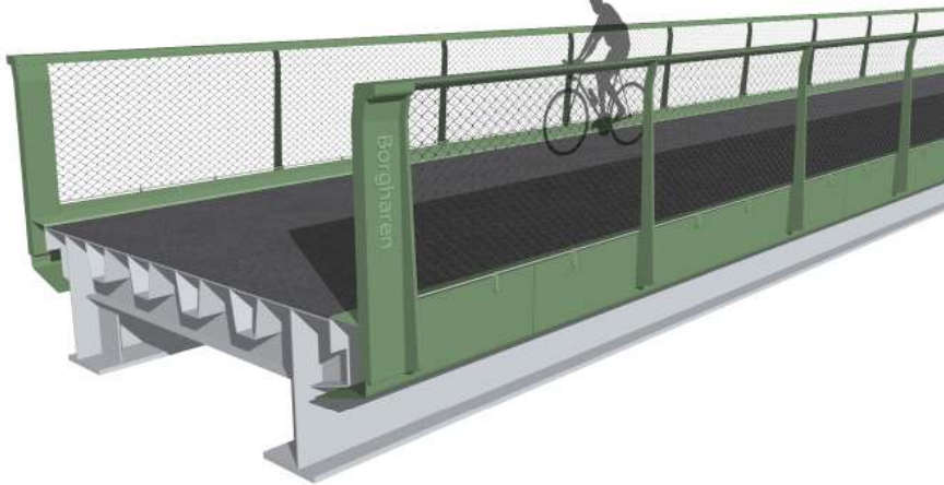
licht verhoogde schikstrook (ca. 8mm) van 250mm zorgt voor strakke rand
