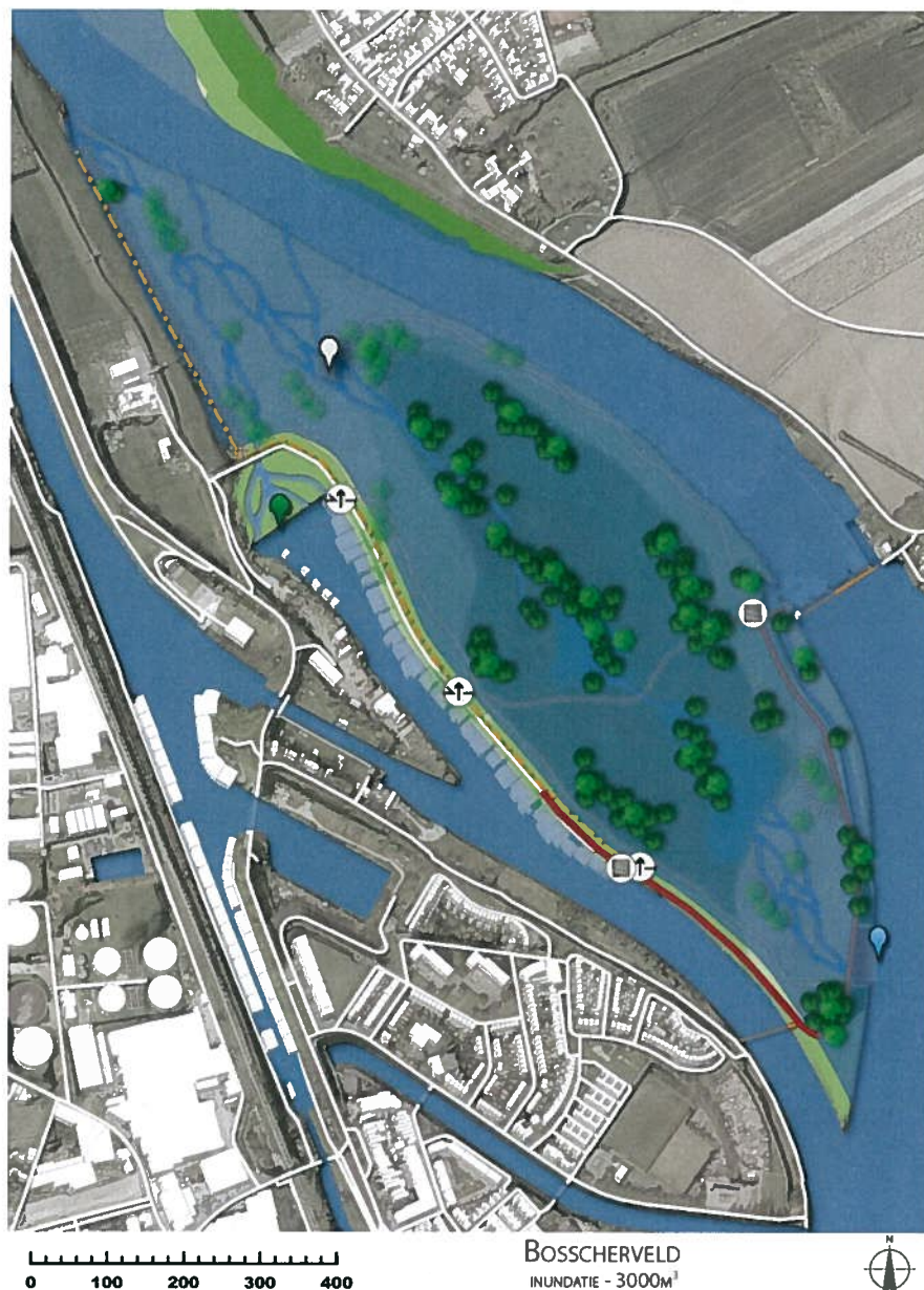
Figuur 4.4c – inundatie bij 3000 m 3 /s (overschrijding 1x per 125 jaar)
