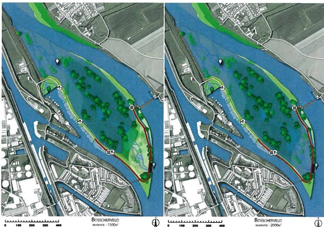
Figuur 4.4b – inundatie bij 1500 m 3 /s & 2000 m 3 /s (overschrijding resp. eens in de 2 en 5 jaar).
