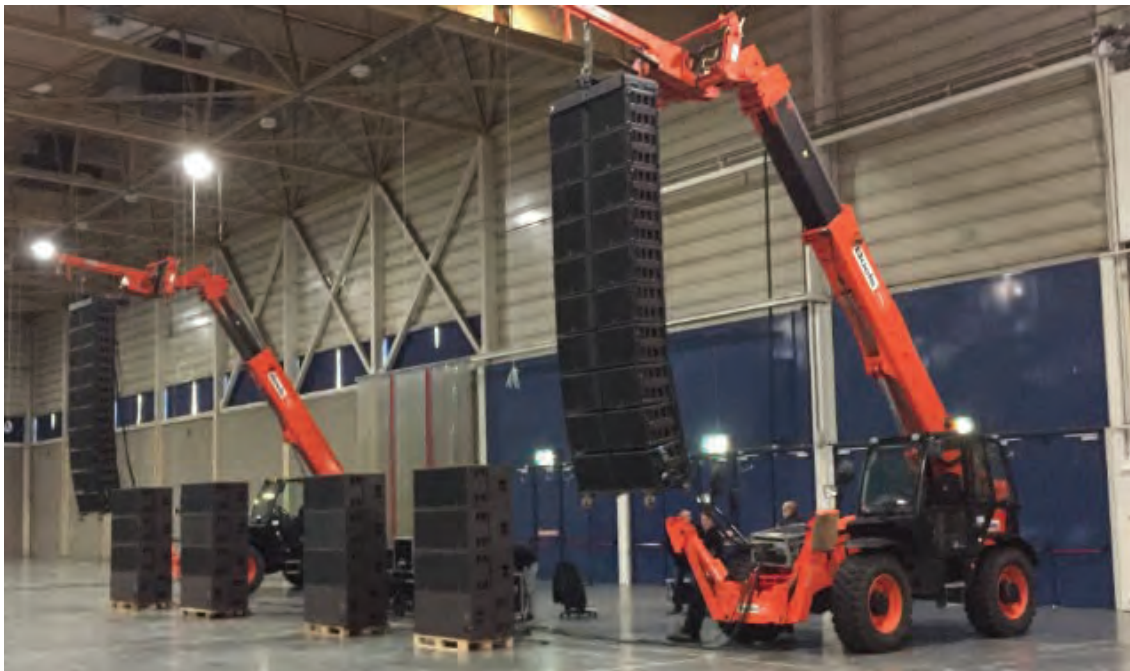
Figuur 3: Geluidinstallatie tijdens de geluidmetingen
