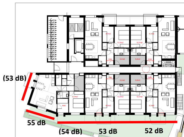
Figuur 5 A1: derde verdieping
