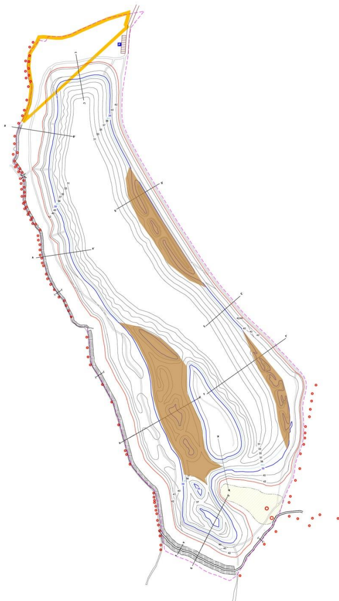
Figuur 20. Kaart met de locaties waar de bodem wordt aangevuld met dekgrond (bruine delen). Dit is de maximale situatie, afhankelijk van de hoeveelheden grind en dekgrond in de bodem kunnen deze vlakken in de eindsituatie kleiner zijn. Het noordoostelijke plas-dras gebied (lagune) is nog optioneel.
