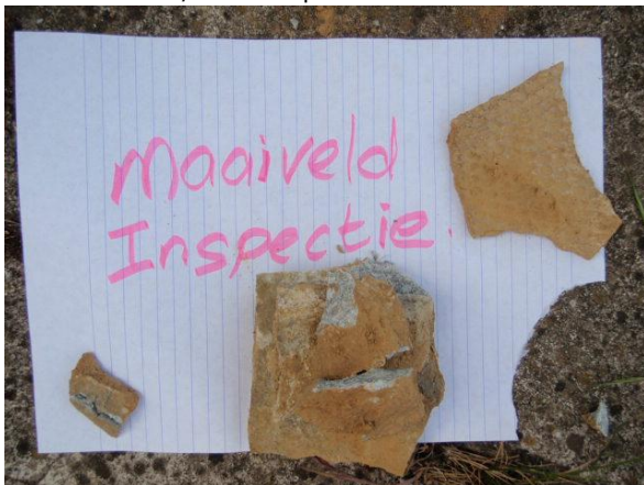
Foto 13: asbestverdacht materiaal aangetroffen op het maaiveld ter plaatse van boring 25, 28 en 36.
