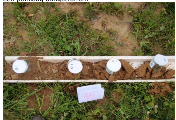
Foto 14: Over het traject van 0-2,0 m-mv van de gehele onderzoekslocatie is leem aangetroffen.
