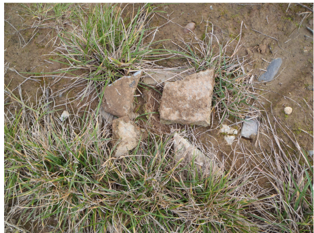
Foto 6: Asbesthoudende materialen bij boorgat 15A.
