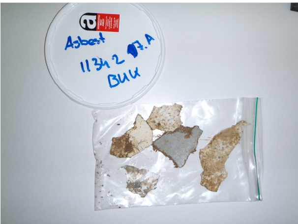
Foto 5: Voorbeelden van asbestverdachte materialen .
