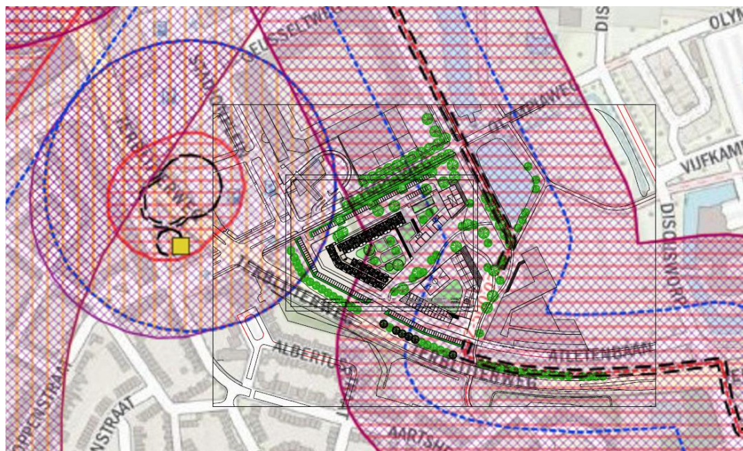
Figuur 3-2 Veiligheidsafstanden bron 6 en 7 t.o.v. te realiseren bebouwing
