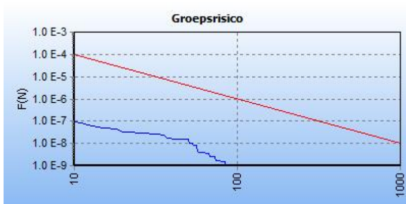
5.10 Figuur 5.10 FN curve voor 7174_leiding-Z-500-15-deel-1_incl verl van N.V. Nederlandse Gasunie voor de kilometer tussen stationing 0.00 en stationing 1000.00
