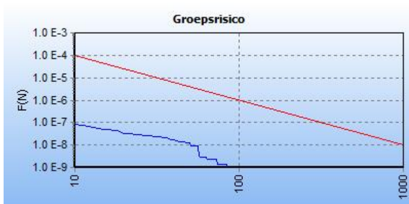
5.5 Figuur 5.5 FN curve voor 7158_leiding-Z-500-15-deel-1_excl verl van N.V. Nederlandse Gasunie voor de kilometer tussen stationing 0.00 en stationing 1000.00
