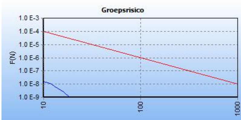
5.2 Figuur 5.2 FN curve voor 7158_leiding-Z-500-05-deel-1_excl verl van N.V. Nederlandse Gasunie voor de kilometer tussen stationing 0.00 en stationing 350.00
