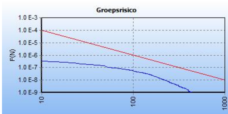
5.5 Figuur 5.5 FN curve voor 7158_leiding-Z-500-15-deel-1_excl verl van N.V. Nederlandse Gasunie voor de kilometer tussen stationing 0.00 en stationing 1000.00
