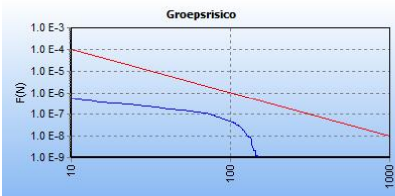
5.2 Figuur 5.2 FN curve voor 7158_leiding-Z-500-05-deel-1_excl verl van N.V. Nederlandse Gasunie voor de kilometer tussen stationing 0.00 en stationing 350.00
