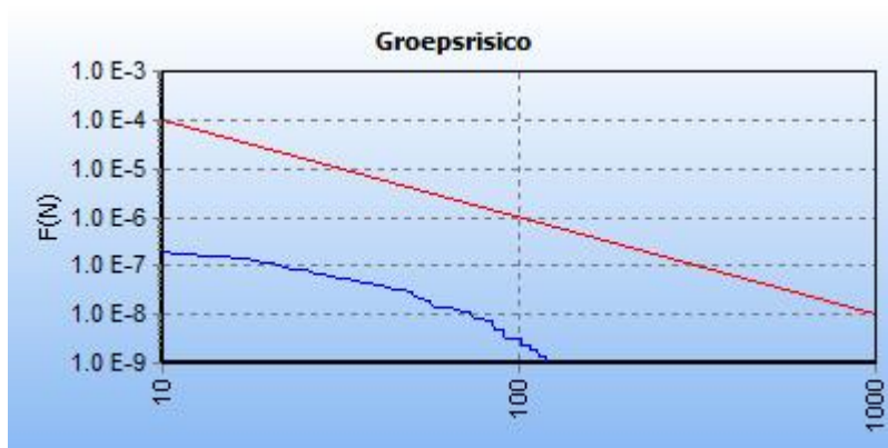
5.8 Figuur 5.8 FN curve voor 7168_leiding-Z-500-16-deel-1_incl verl van N.V. Nederlandse Gasunie voor de kilometer tussen stationing 0.00 en stationing 1000.00
