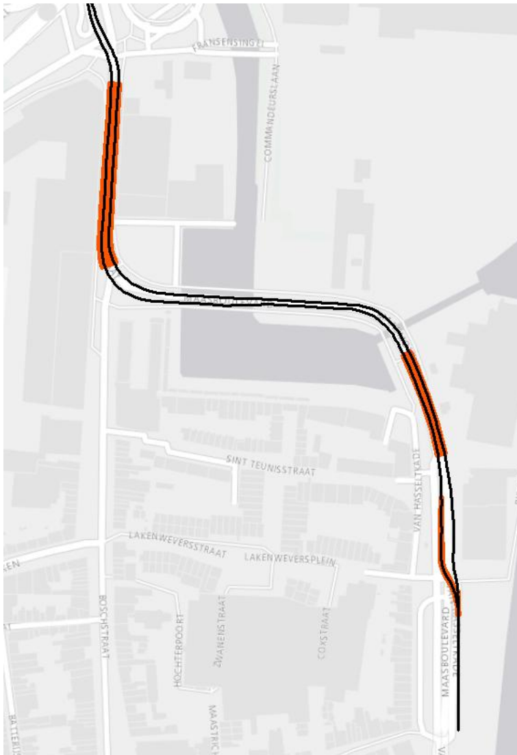
Figuur 7 Trillingsmaatregelen voor eindhalte Mosae Forum (rood = floating slab)
