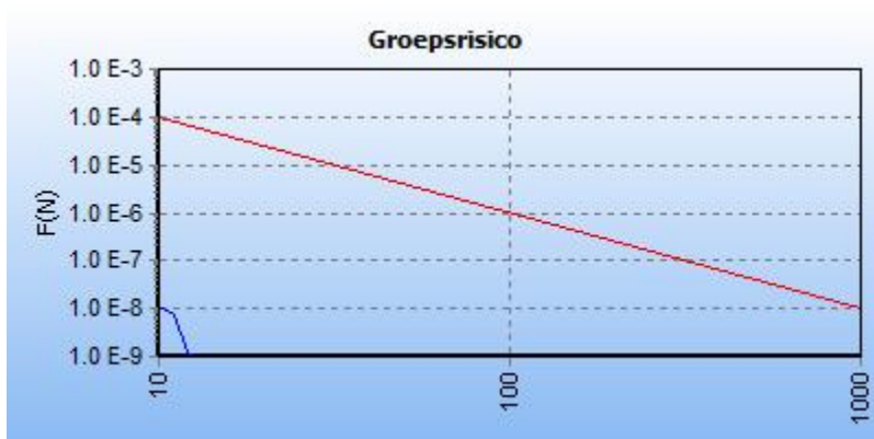
Afbeelding 8 fN-curve buisleiding A-645-deel-1
