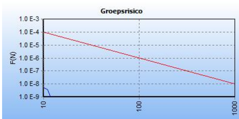
Afbeelding 6 fN-curve buisleiding A-578-deel-1
