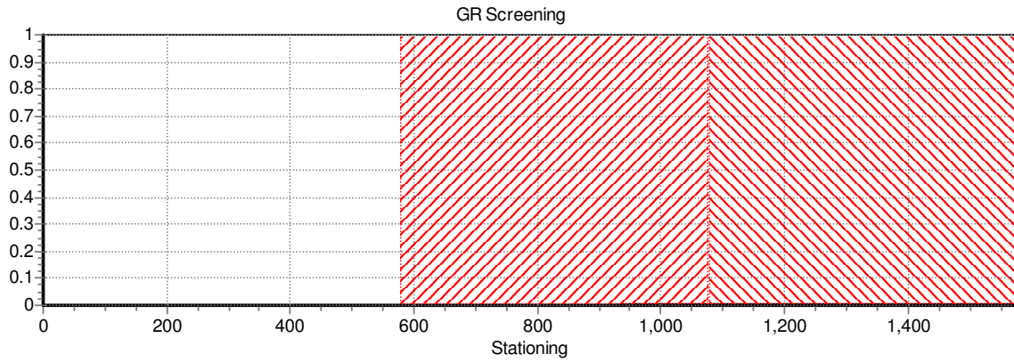
Figuur 3 Overschrijdingsfactor uitgezet tegen stationing van de Z-518-01-KR-026, bestaande situatie. Het rood gearceerde deel geeft de kilometer aan waarover de FN-curve is berekend.
