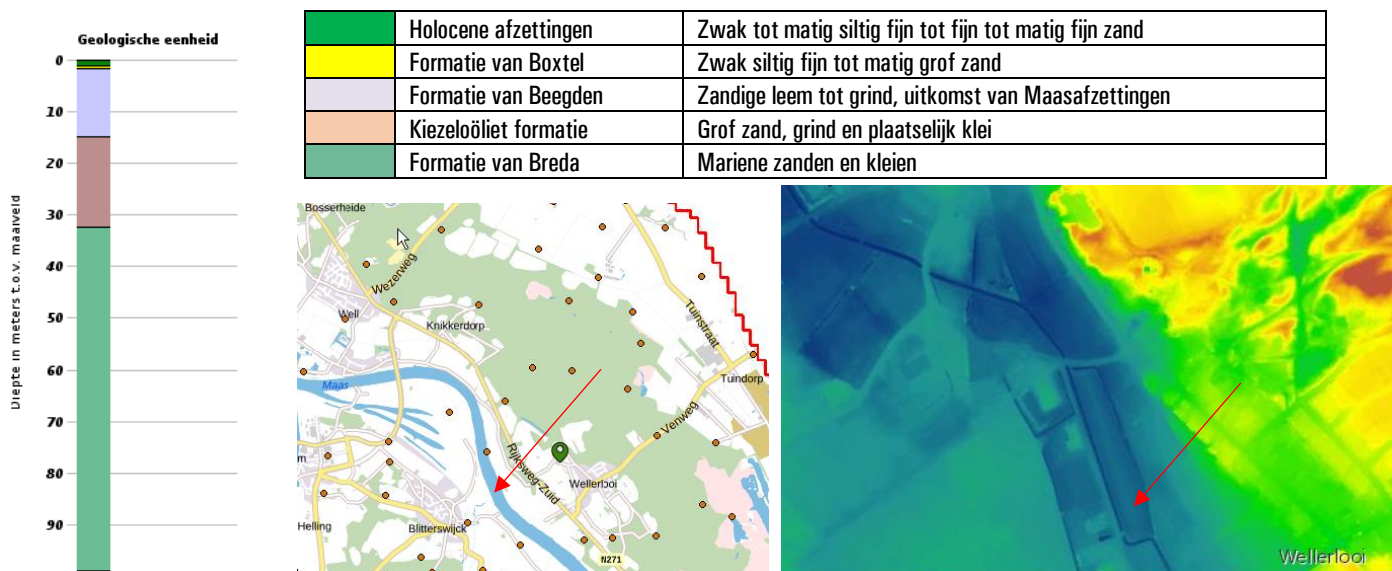
Figuur A: opbouw ondergrond.
