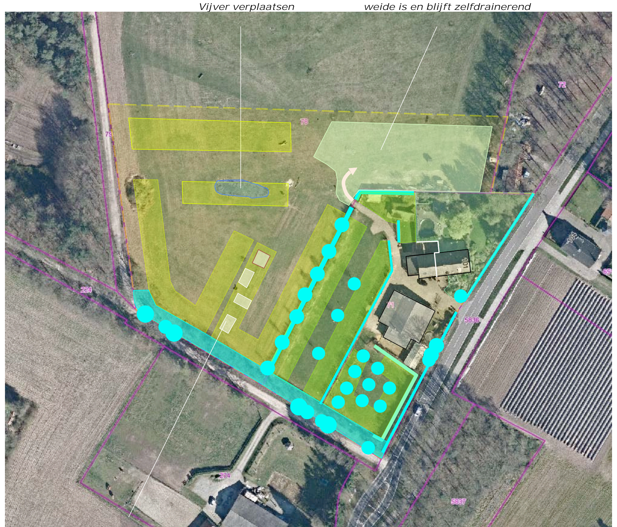
dakwater van vaste accommodaties wateren af op ter plaatse te graven greppels
